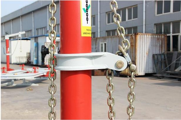
Detalle de polea móvil en columnas
