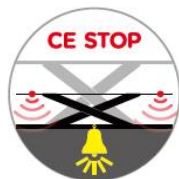
PARADA AUTOMÁTICA Y ALARMA EN DESCENSO
