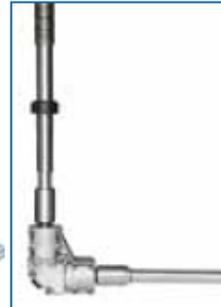
Transmisión entre las columnas por cardan y cajas de engranajes selladas en baño de aceite que no requieren mantenimiento alguno.
